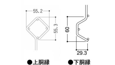
**案内** ●自在柱と本体連結部及び端部の間隔は、150mm以内で施工してください。それ以上離れると強度が低下します。
