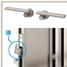
レバーを下げると錠が框に収納されて扉の開閉が可能に。扉を閉めてレバーを水平に戻すと錠が出て扉を固定します。
