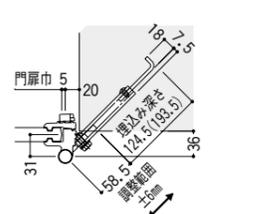
●スチールアンカーが付いていますので、鉄筋に溶接できます。
