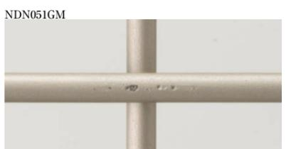
セレビュー門扉9型・10型は製法上、メッシュ線材の溶接部表面(溶接箇所)に溶接痕が発生します。溶接痕は高い耐候性を維持する複合皮膜処理を施しているために発生するもので、商品の品質上問題はありません。(写真はCBステン)
