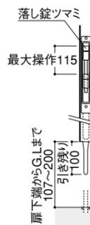
傾斜地に門扉を設置される場合、便利な足長落し錠部品があります。標準の落し棒にカートリッジ部品を取り付けることにより地面(G.L.)から扉下面まで最大200ミリまでの対応ができます。
